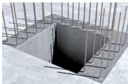
Connessioni di barre di armatura
